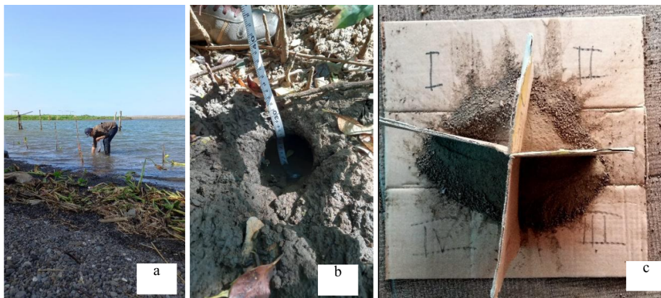
■ Gambar 3 Pengambilan sampel endapan sedimen dilakukan di tepi pantai (a) dan di rawa pantai (b). Kegiatan pre-parasi sampel sedimen dilakukan di laboratorium (c).
